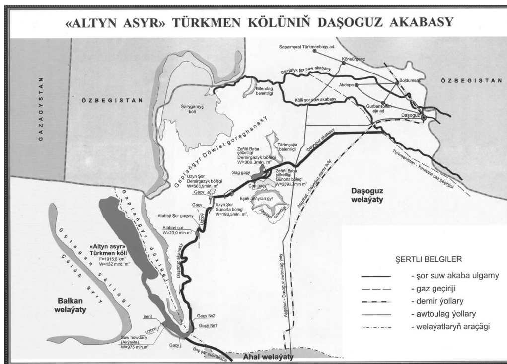
Рис. 2. Схема строительства озера Алтын Асыр и системы подводящих коллекторов в северной части проекта
