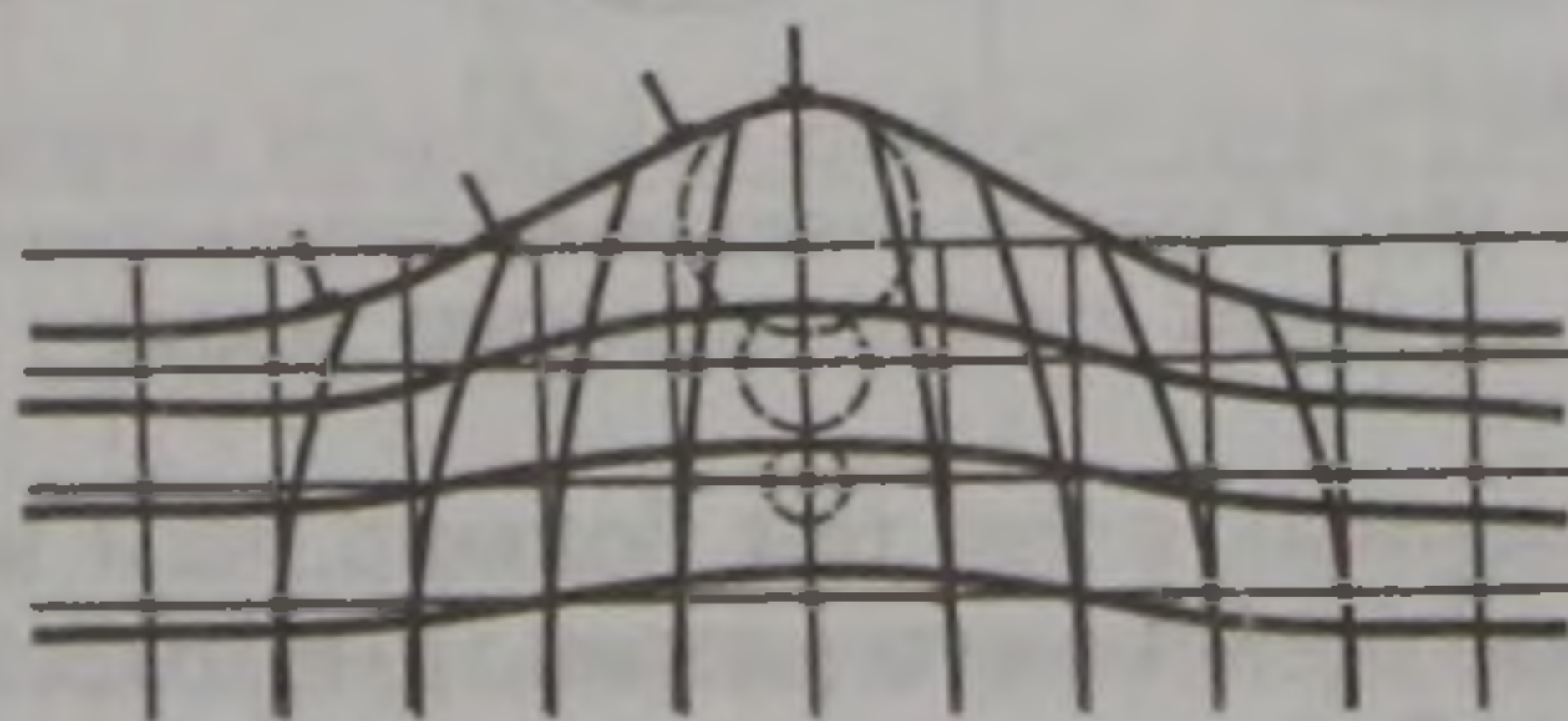
Рис. 10.9. Вертикальное строение волны зыби. На поверхности волны показаны поплавки, пунктиром показаны орбиты частиц
