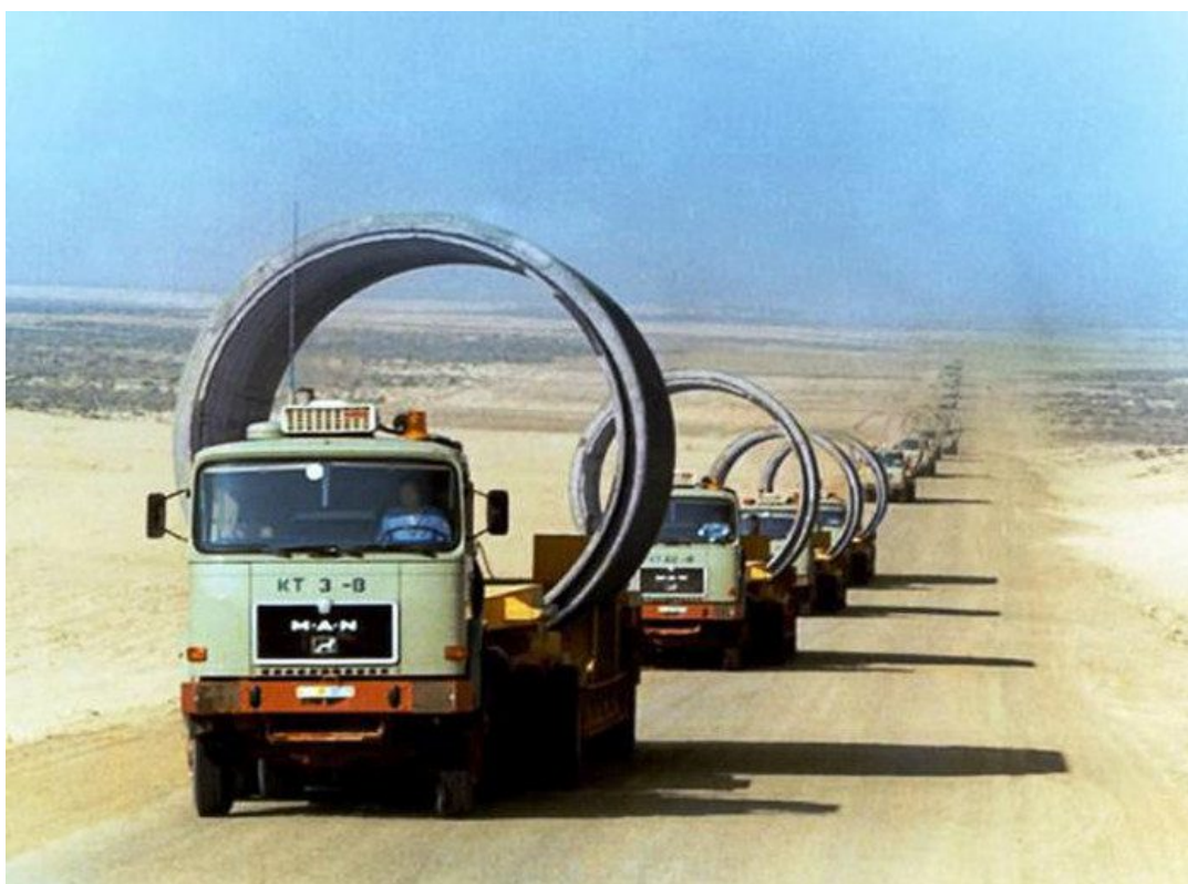
Рис. 4.4 – транспортировка звеньев водовода.
