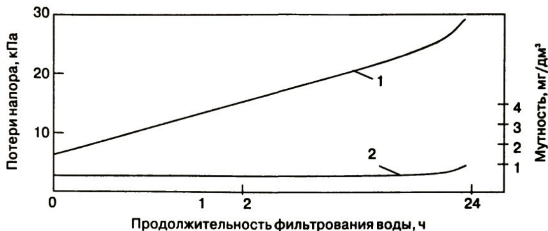
Рис. 1.9. Зависимость перепада давления (1) при фильтрации воды через загрузку и содержания мутности в фильтрате (2) от продолжительности фильтрации воды с начала фильтроцикла
