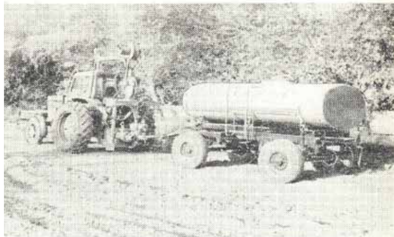
Машина для очистки смотровых колодцев на закрытых дренах КОРД-5,0
