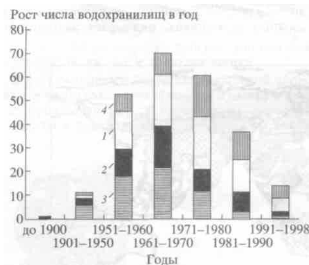
Рис. 4. Строительство крупных водохранилищ (объёмом более 0,1 км 3 ) в XX в. 1 — Азия, 2 — Европа, 3 — Северная Америка, 4 — другие регионы (Латинская Америка, Африка, Австралия и Океания) [4]
