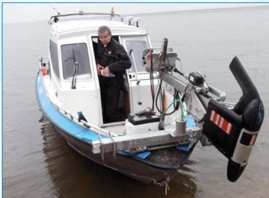
Данный комплект оборудования использует многлучевые многочастотные излучатели, работающие в указанном диапазоне частот и позволяющие проводить съемку рельефа дна и определение мощности слоя иловых отложений на глубинах до 100м.
