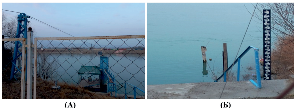
Рисунок 13. Гидропост «Кызылқишлак». А- Система автоизмерения уровня; Б- Стационарная рейка
