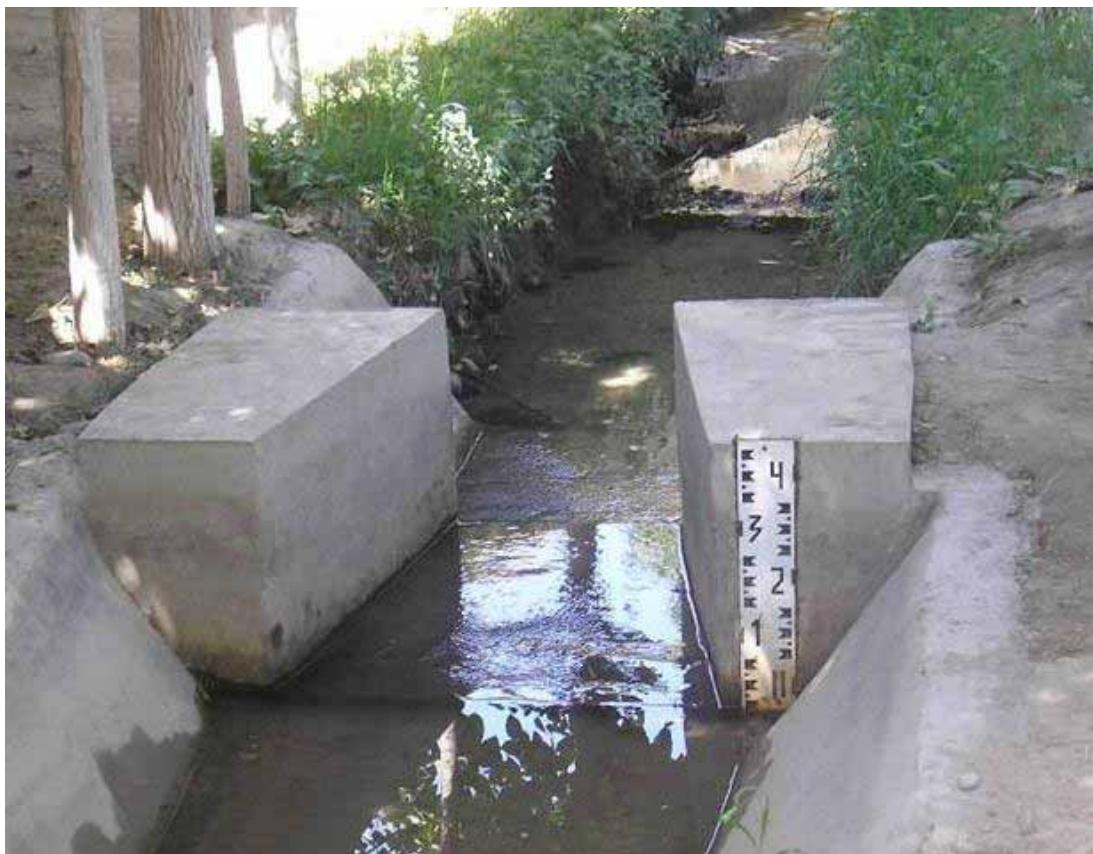
**Рис. 5. Водомерный лоток САНИИРИ**
