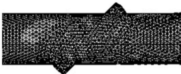
**Рис. 12. Сетка ультразвукового расходомерного узда**
