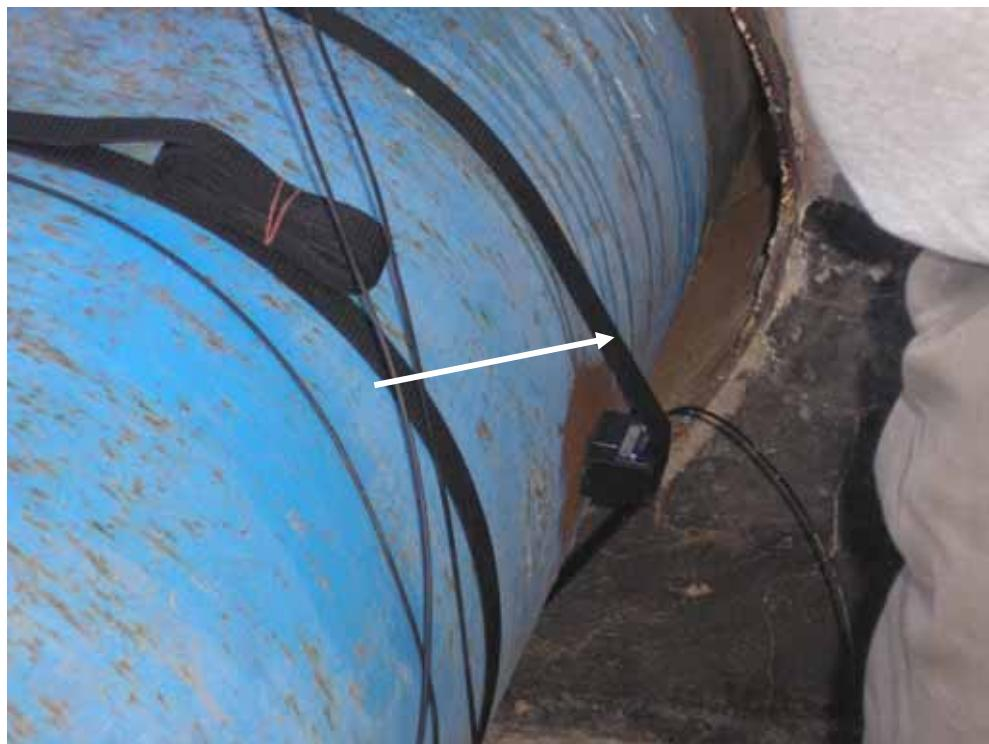
**Ультразвуковые датчики установленные на поверхности напорного трубопровода**
