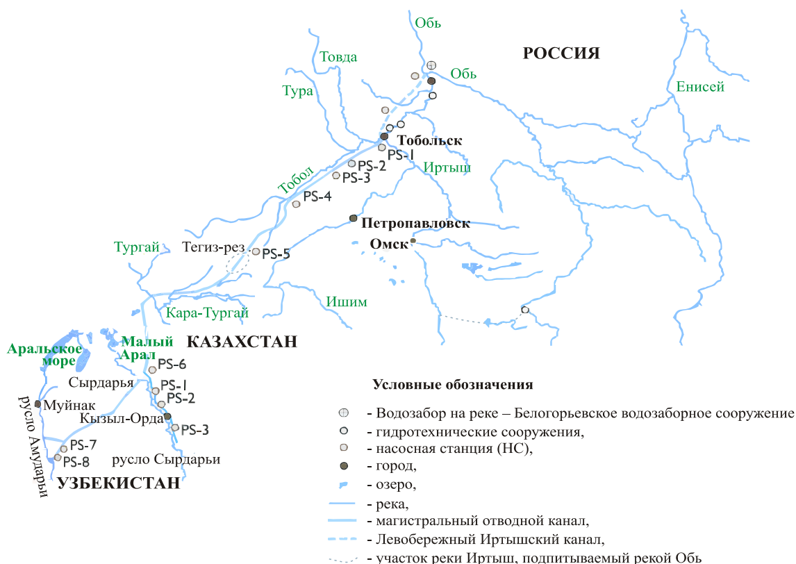
Рис.1 Схема переброски стока рек Иртыш и Обь в бассейны Аральского и Каспийского морей (Герасимов и Гиндин, 1976 г.)
