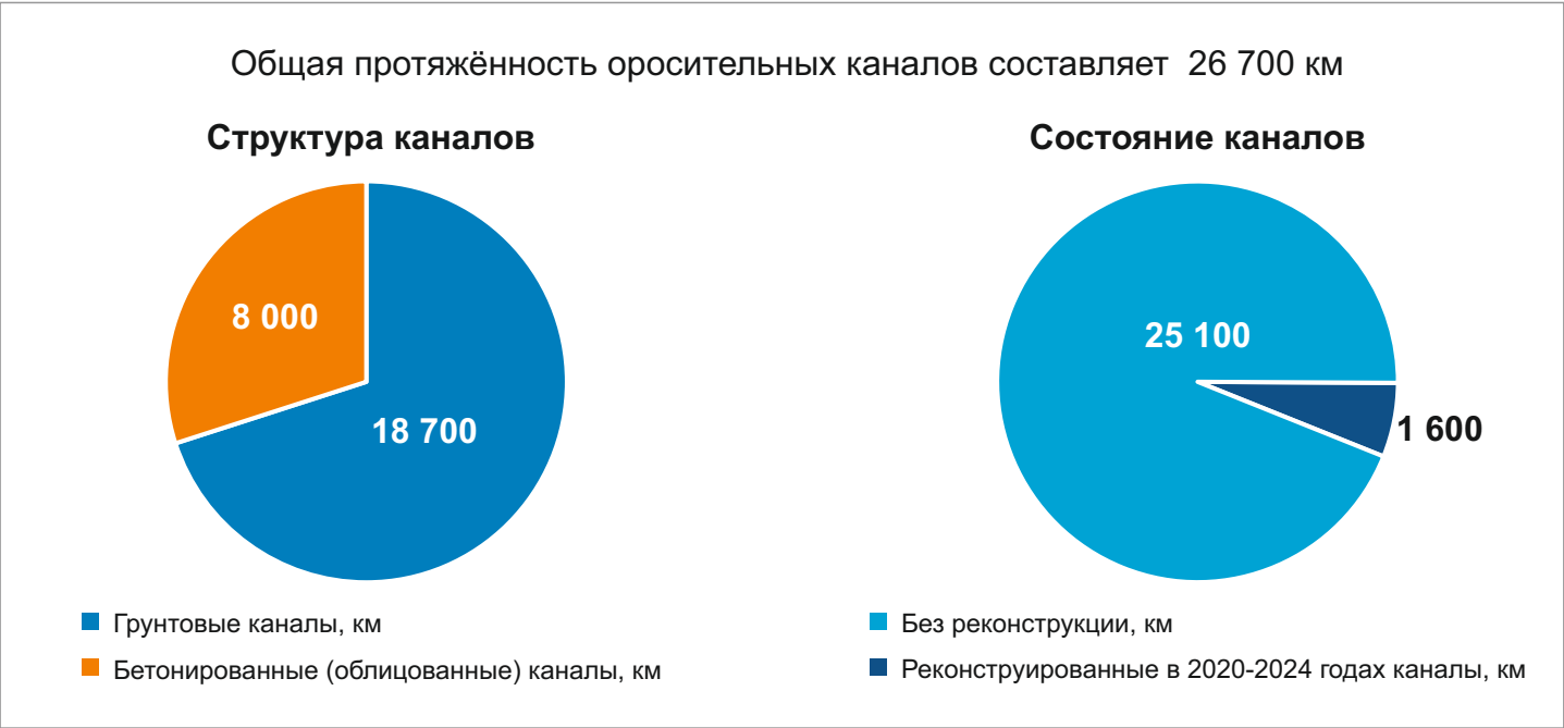
Рисунок 3 Общая протяжённость оросительных сетей Кыргызской Республики, их структура и состояние
