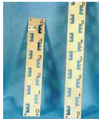
Рис. D. Рейка уровнемерная гидромелиоративная РУГ
