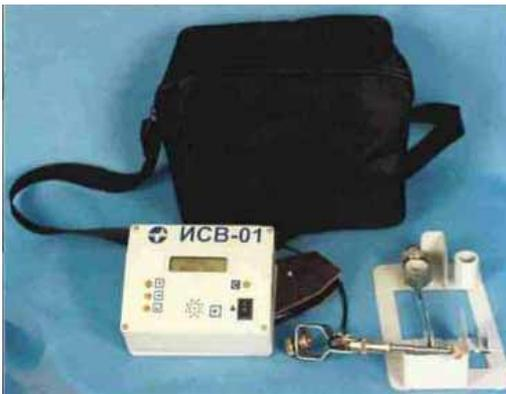
Рис. А. Измеритель скорости воды ИСВ-01
