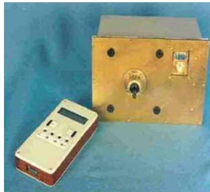
Рис. В. Устройство контроля технологических параметров водного потока УКТП-2
