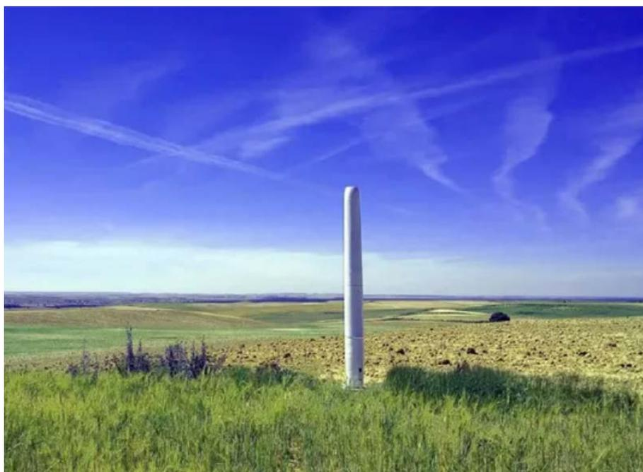
На вид их изобретение похоже на дорожный столбик. У него нет лопастей или лопаток. Энергию оно производит за счет автоколебаний – физического явления, когда твердое тело в движущемся потоке жидкости или газа начинает совершать гармонические осцилляции.
