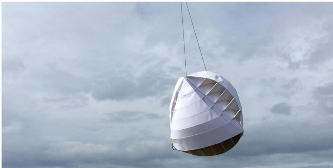
Конструкция устройства полностью напоминает другую технологию, разработанную NASA и известную как турбина Савониуса. Это сфера диаметром 25 см с небольшими отверстиями, через которые ветер может свободно дуть с четырех сторон. Когда потоки воздуха проходят поперек сферы, они поворачивают турбину вокруг своей оси, что приводит к выработке электроэнергии.
