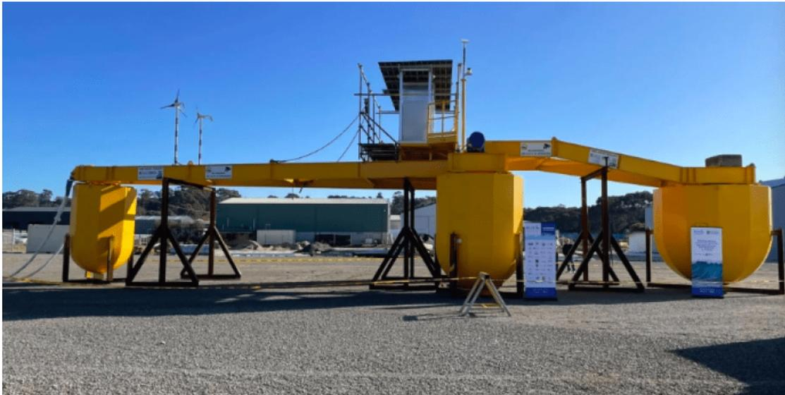
Moored MultiMode Multibody (M4) преобразует энергию волн и имеет впечатляющие размеры. Следующие полгода устройство будут тестировать на эффективность, а затем большую модель построят и развернут на море. Об этом пишет New Atlas.
