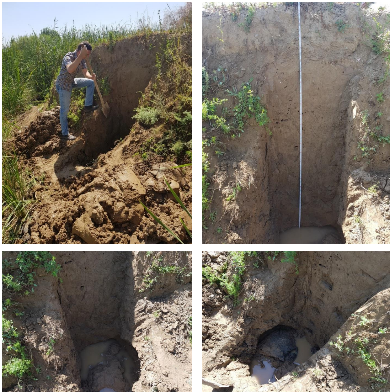
Рис. 2.2.3. Отбор проб грунтов для определения гранулометрического состава грунтов откоса коллектора
