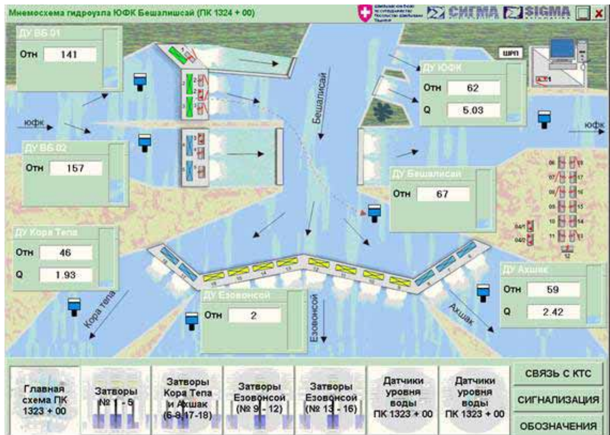
Рис.16. Сооружение Хамза главная мнемосхема системы SCADA
