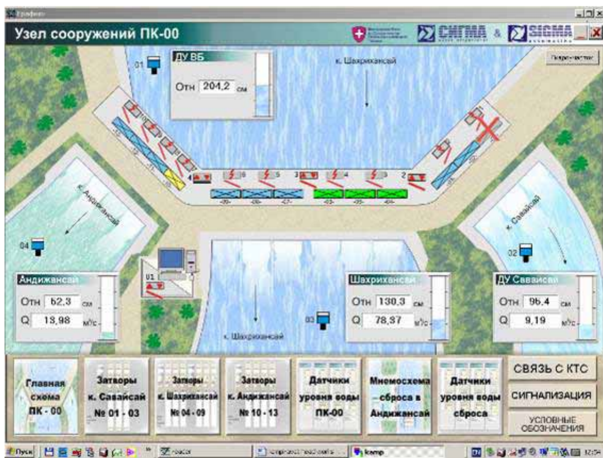
Рис. 12. Кампирраватский гидроузел главная мнемосхема системы SCADA
