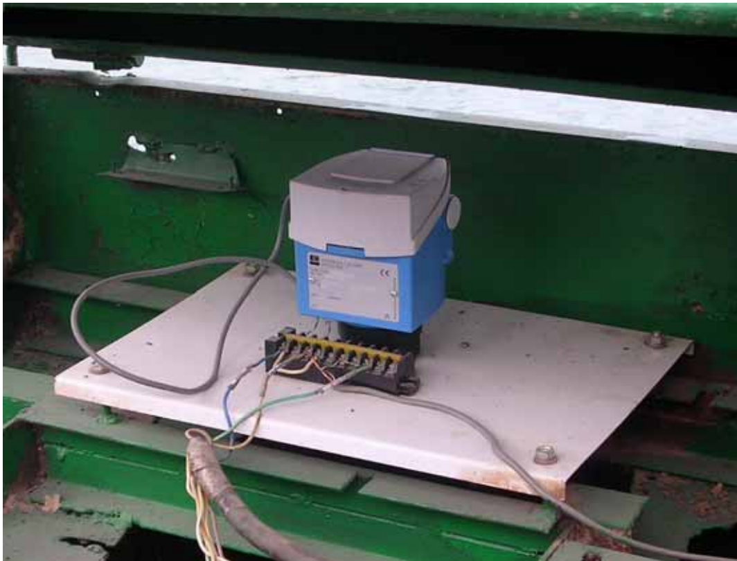
Рис. 1. Датчик уровня воды
