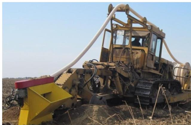
Рисунок 6 – Экскаватор ЭТЦ -208 с экспериментальным бункером
