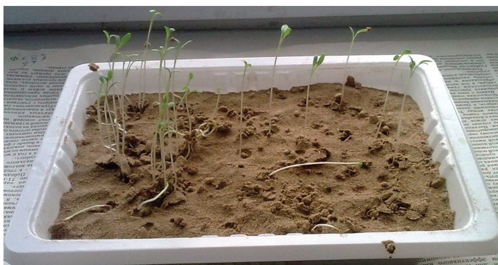
Рис. 3. Всходы растений под коркой закрепителя
