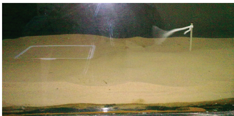
Рис. 2. Продувка образцов корок в аэродинамической трубе
