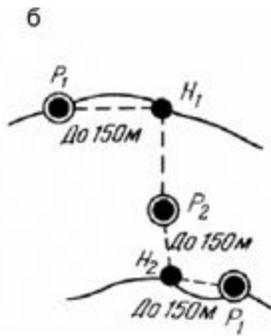
Рисунок 1. Схема нивелирования через препятствие
