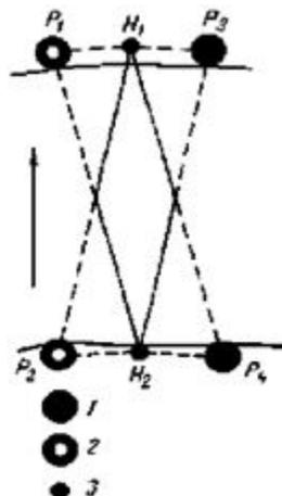
Рисунок 3. Передача высоты через водное препятствие шириной 150 м вторым способом
