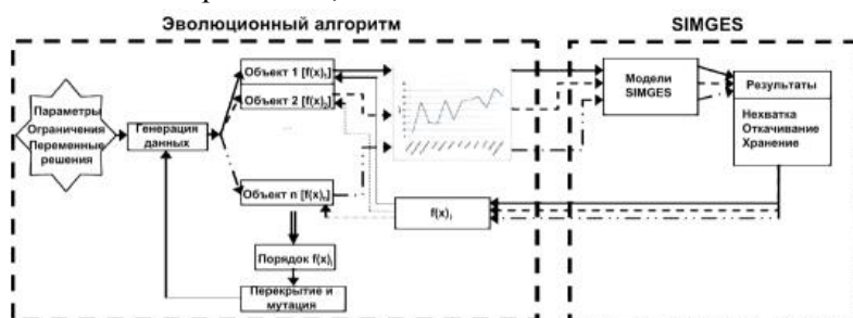
Рисунок 2.4.3: применение эволюционных алгоритмов для разработки оптимальных правил эксплуатации водоресурсной системы
