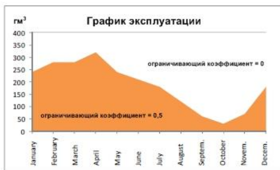
Рисунок 2.5.7: график эксплуатации для уменьшения экологических стоков в засушливые годы
