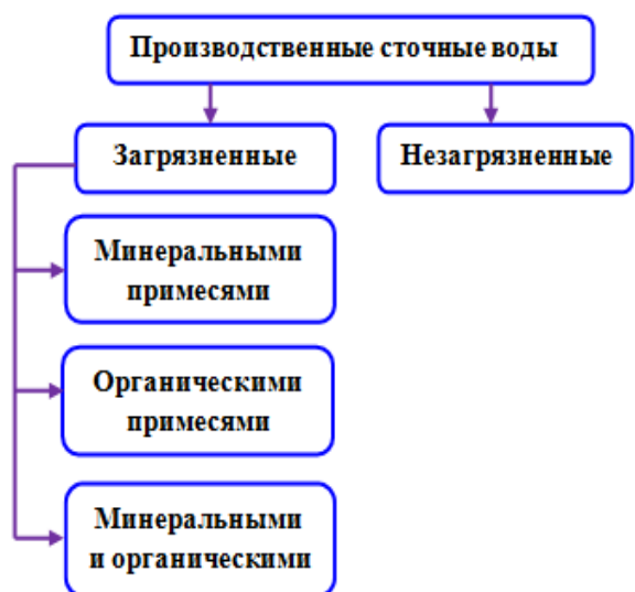
Рисунок 4.7.1 Категории производственных сточных вод
