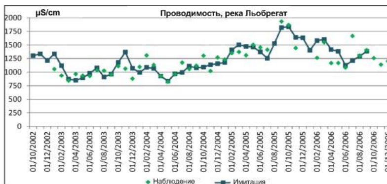
Рисунок 2.3.5: пример использования GESCAL для сравнения реальной и прогнозируемой проводимости реки Льобрегат, Испания
