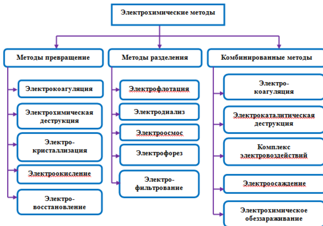
Рисунок 4.8.1. Классификация электрохимических методов очистки воды
