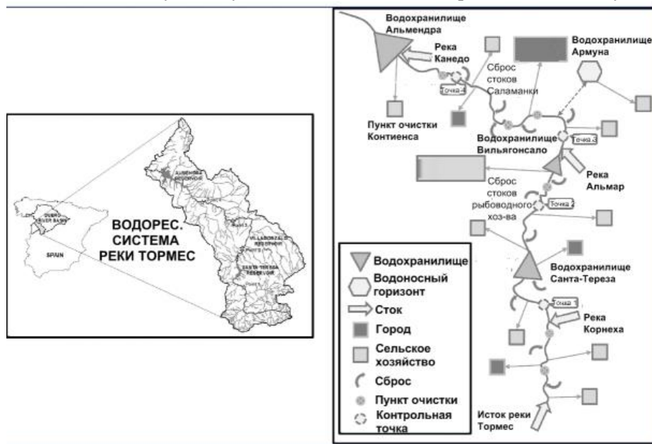
Рисунок 2.5.3: основные элементы водоресурсной системы реки Тормес
