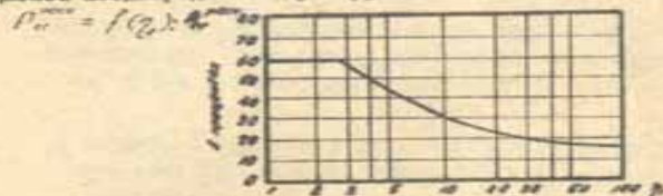
Рис.2.1.График для определения расчетных размеров сводообразующих частиц грунта (по А.Н.Патраеву, Г.Х. Цараеву).
