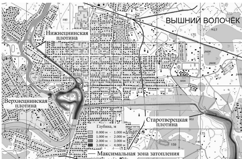
**Рисунок 4 – Зоны затопления при прохождении волны прорыва по пойме р. Тверцы и Цны**
