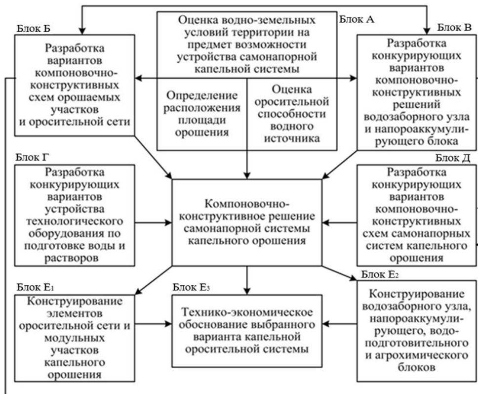
**Рисунок 3 – Блок-схема технологии разработки и выбора компоновочно-конструктивных решений самонапорной системы капельного орошения**
