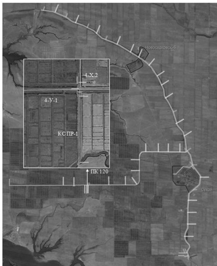
**Рисунок 2 – План-схема расположения поперечных профилей на исследуемом участке Пролетарского канала**
