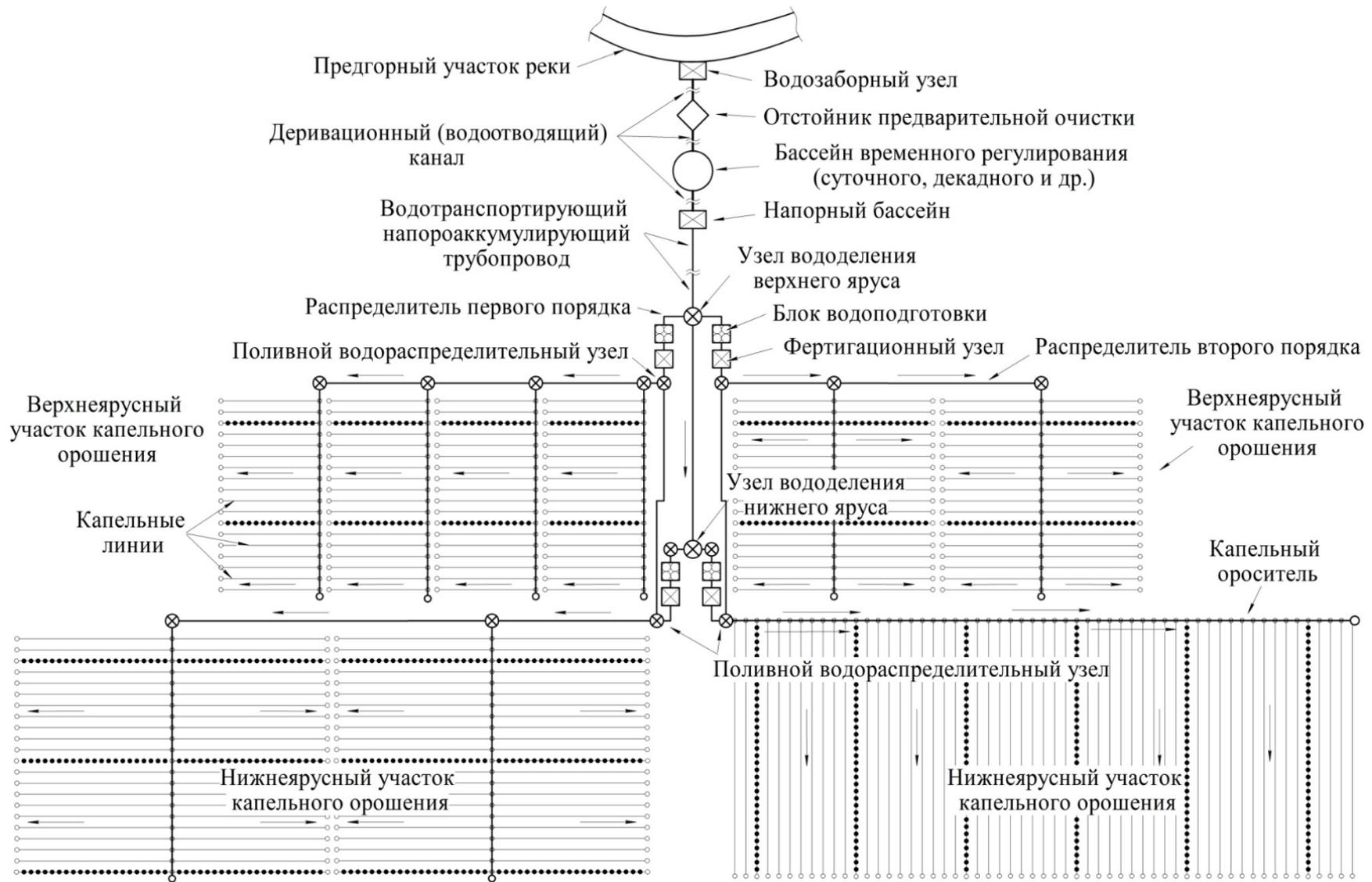
Рисунок 1 – Схема полносамонапорной системы капельного орошения
