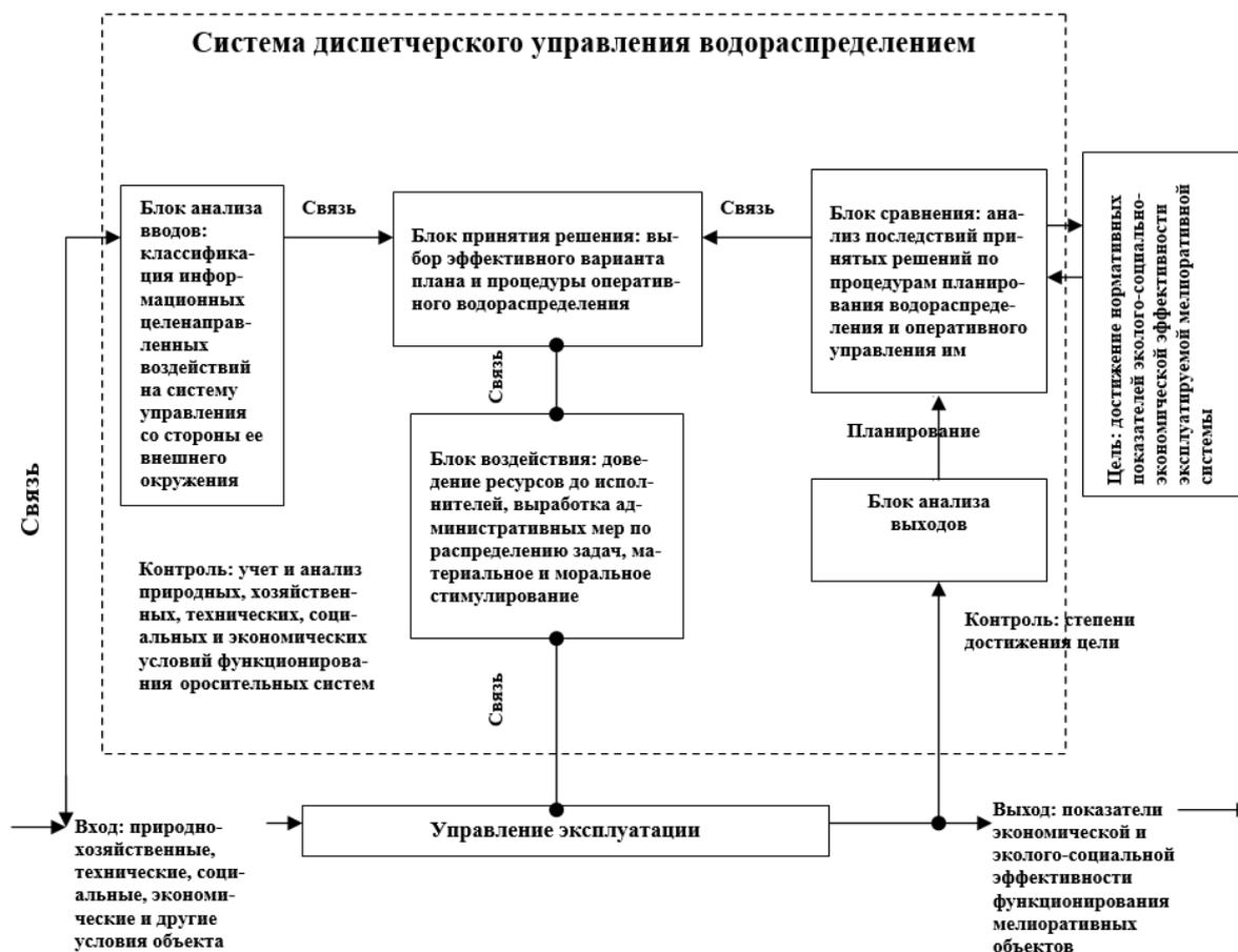
**Рисунок 1 – Функции принятия и реализации решений по водораспределению в информационно-кибернетическом процессе управления оросительной системой**
