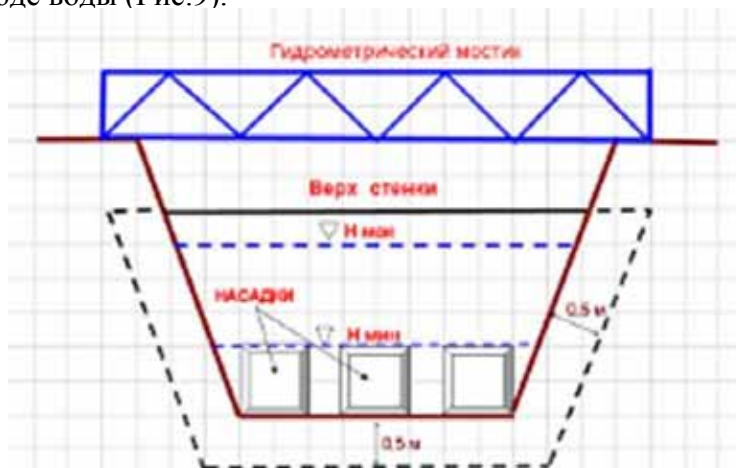
Рис.9. Водомерное устройство типа «СНС»
