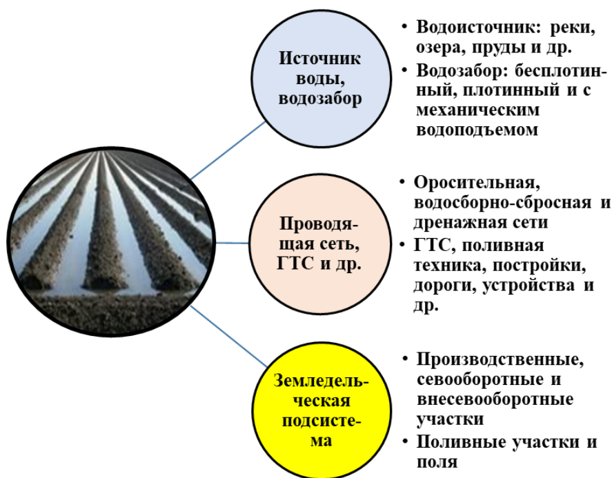
Рисунок 3 – Схема простой технической оросительной системы (второй уровень ранжирования)
