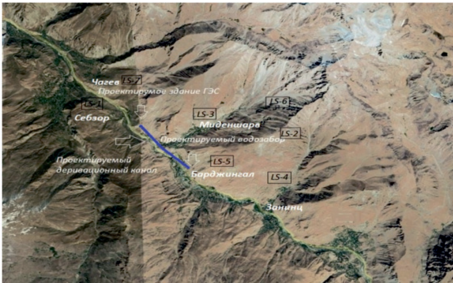
Рис. 1. Расположение оползнеопасных склонов на территории, прилегающей к возводимой малой ГЭС «Себзор». Синей линией показан проектируемый деривационный канал. Подложка: мозаика снимков с сервиса Google Earth
