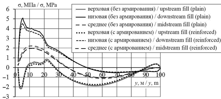
Рис. 5. Изменение по высоте продольных напряжений в бетоне экрана при модуле линейной деформации каменной наброски 120 МПа
