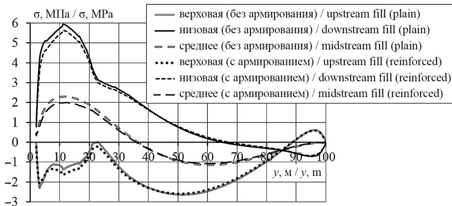
Рис. 4. Изменение по высоте продольных напряжений в бетоне экрана при модуле линейной деформации каменной наброски 60 МПа
