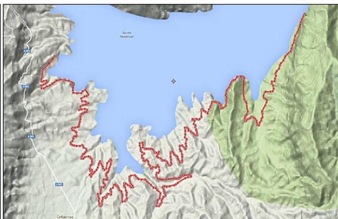
Рис. 3.8. Линия устройства дамбы обваловывания на левом борту Нурекского водохранилища
