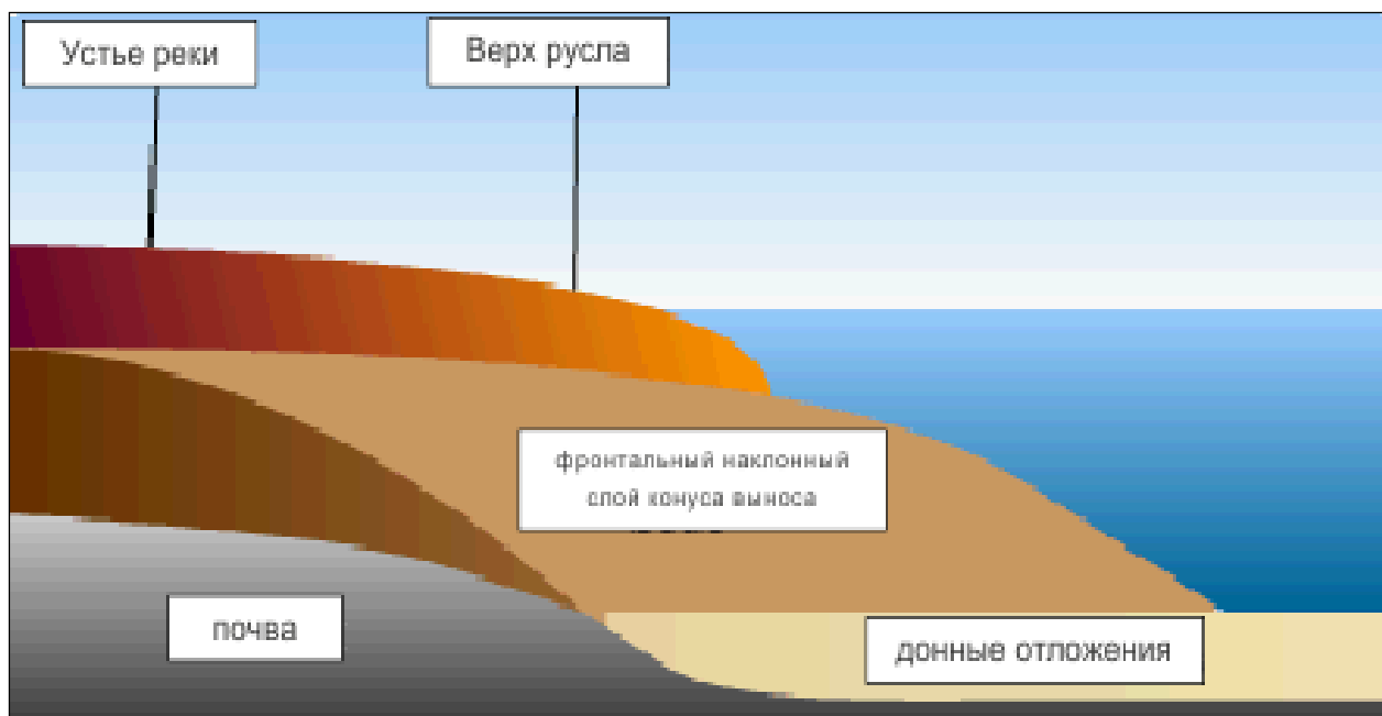
Рис. 4.8. Модель фракций для преобладающей дельты реки: последовательность осадочных фракций, связанных с различными регионами системы дельты
