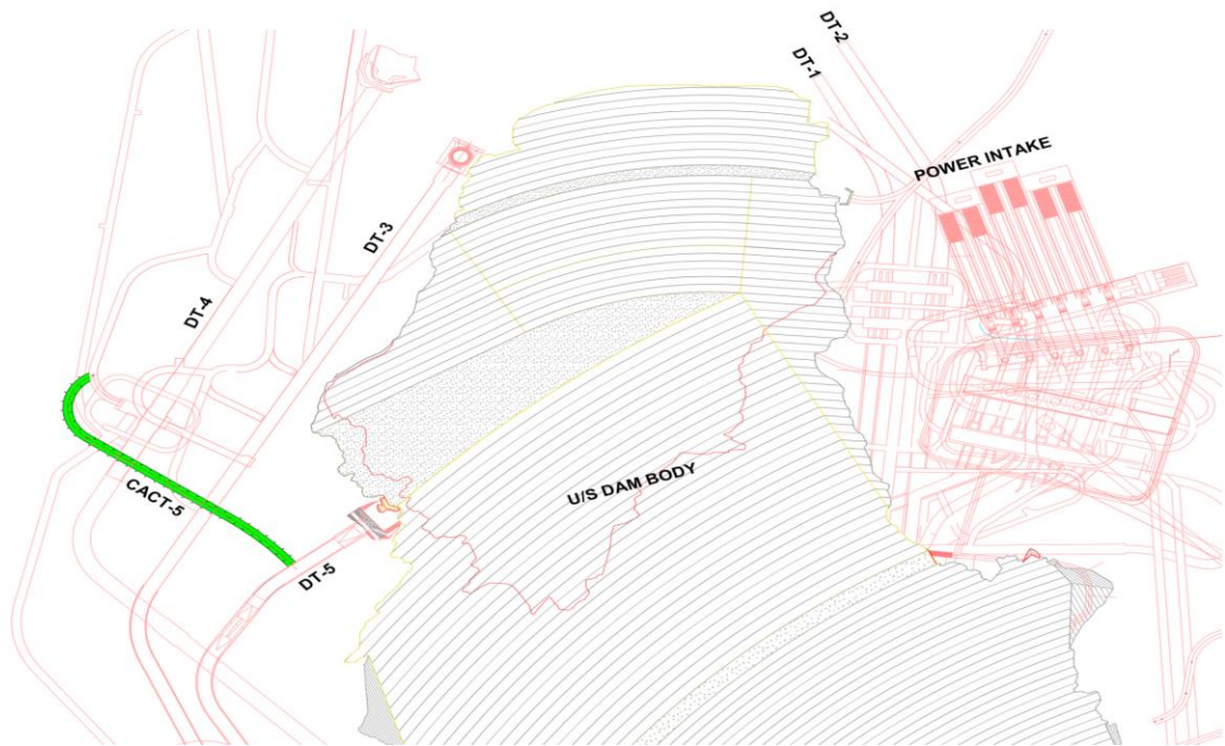
Рисунок 1. Общая схема подходного тоннеля П-5 Рогунской ГЭС
