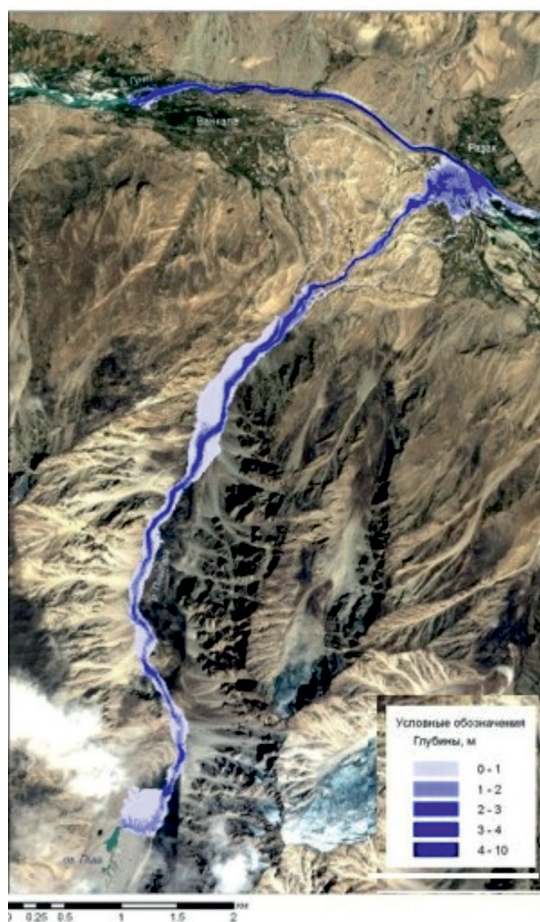
Рис. 17. Глубины затопления в долине р. Пишдара при сценарии I (а) по результатам моделирования на основе программного комплекса FLO-2D
