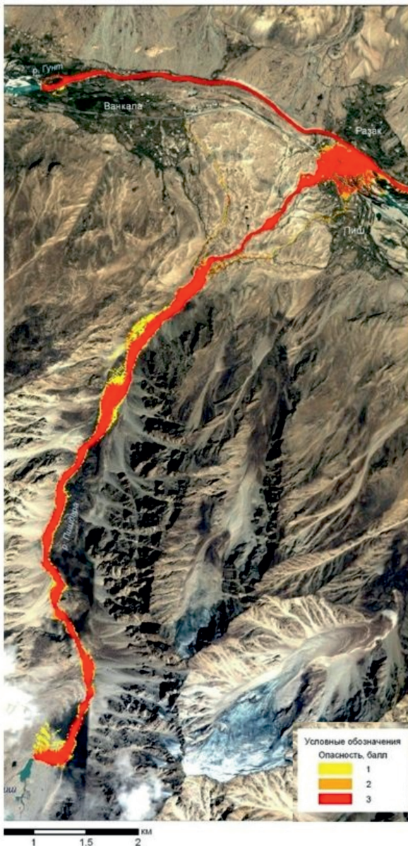
Рис. 19. Потенциальная опасность (в) в устье р. Пишдара при сценарии прорыва I по результатам моделирования с применением программного комплекса FLO-2D
