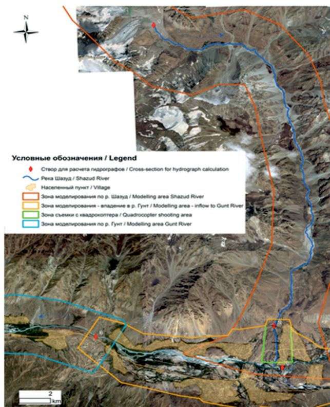
Рис.4. Схематизация модельной области при моделировании прорывных потоков по р. Шазуддара.
