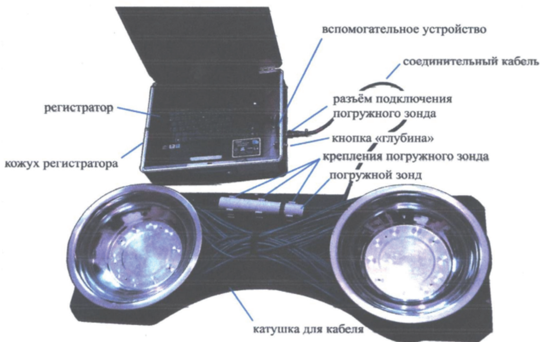
Рис. 2. Элементы кондуктометра
