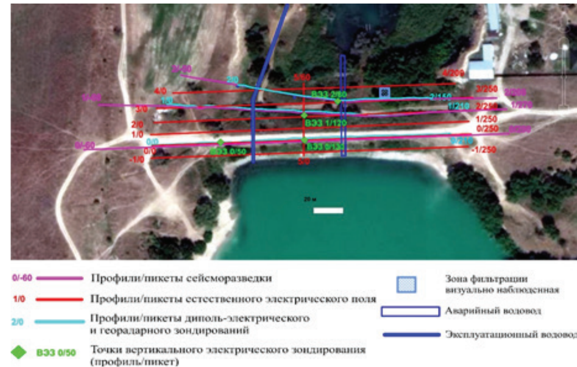
Рисунок 1. Система профилей и точек наблюдения полевых геофизических съёмок по плотине К-25
