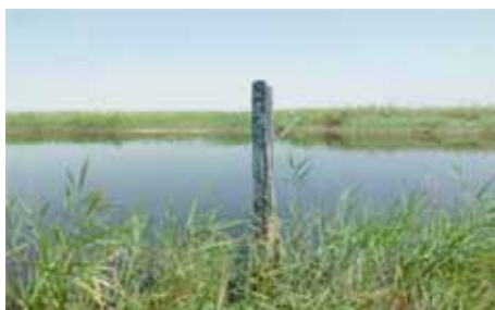
Гидропост для замера уровня воды на озере Судочье
