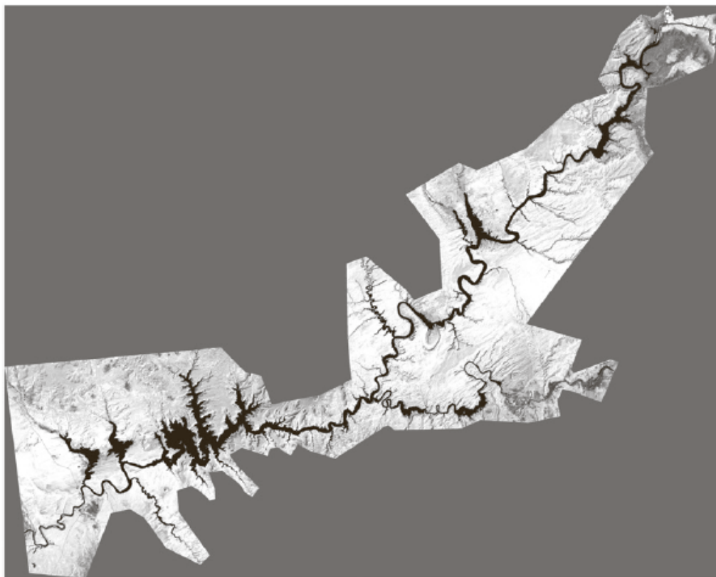
Рис.1. Маска воды (черным), полученная с использованием снимков Landsat 5 (9 июня 2004 г.) озера Пауэлл в США и метода на основе индексов NDWI и MNDWI
