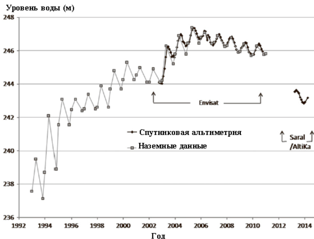
Рис.6. Изменения отметок уровня воды в озере Айдаркуль, полученные с помощью измерений радарной альтиметрии на альтиметрах ENVISAT и SARAL/AltiKa (даты измерений – средние даты четырех пролетов каждые 35 дней) и наземных данных на даты минимального и максимального уровня каждого года (из базы данных Sawater)
