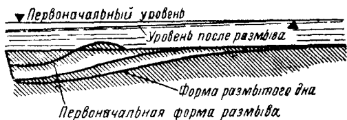
Рис. 4. Различные стадии размыва дна нижнего бьефа (продольный профиль).
