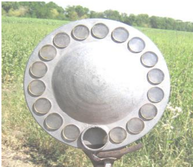
Рис. 12. Прибор для получения отпечатков водяных капель КР-2
