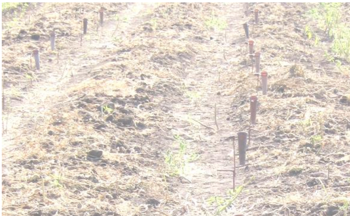
Рис. 10. Схема расстановки дождемерных бачков при поливе ДКФ-1ПК
