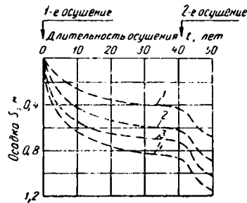
Рис. 56. Зависимость осадки торфа от длительности осушения (по Р. Эггельсманну). H — глубина торфа: 1 — H = 1,7 \pm 0,07 м; 2 — H = 2,24 \pm 0,08 м; 3 — H = 3,07 \pm 0,01 м; 4 — H = 3,62 \pm 0,15 м.
