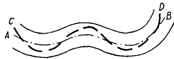
Фиг. 13. Фарватер и динамическая ось в русле с симметричной неизменной по длине формой русла.
