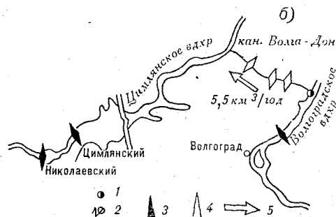
Рис. 12. Продольный профиль (а) и схема (б) трассы переброски части стока р. Волги в р. Дон.
