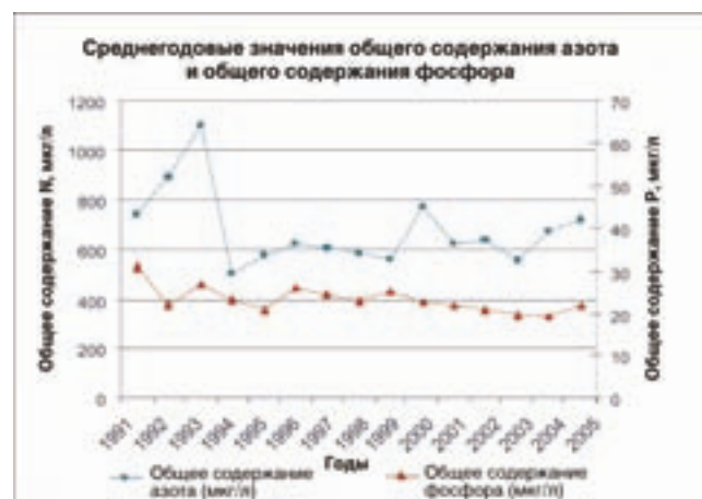
Среднегодовые значения общего содержания азота и общего содержания фосфора в финской части озера Нуйямаанярви
