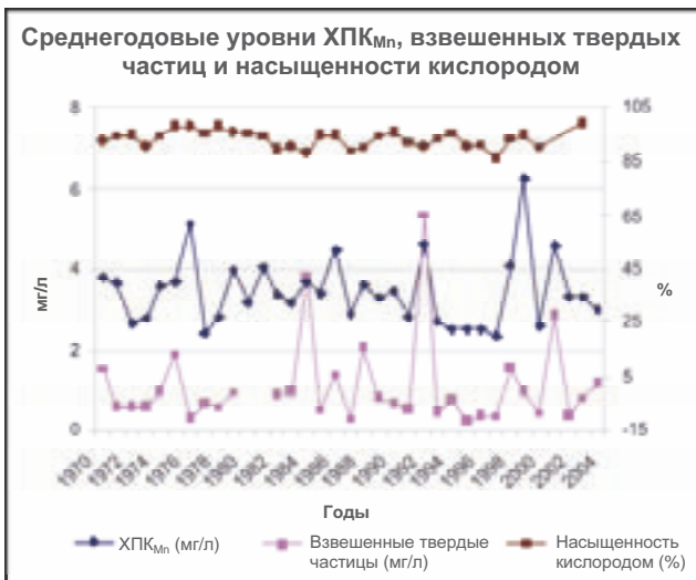
Среднегодовые показатели химической потребности в кислороде, взвешенных твердых частиц и насыщенности кислородом на станции Тенойоки (Финляндия)
