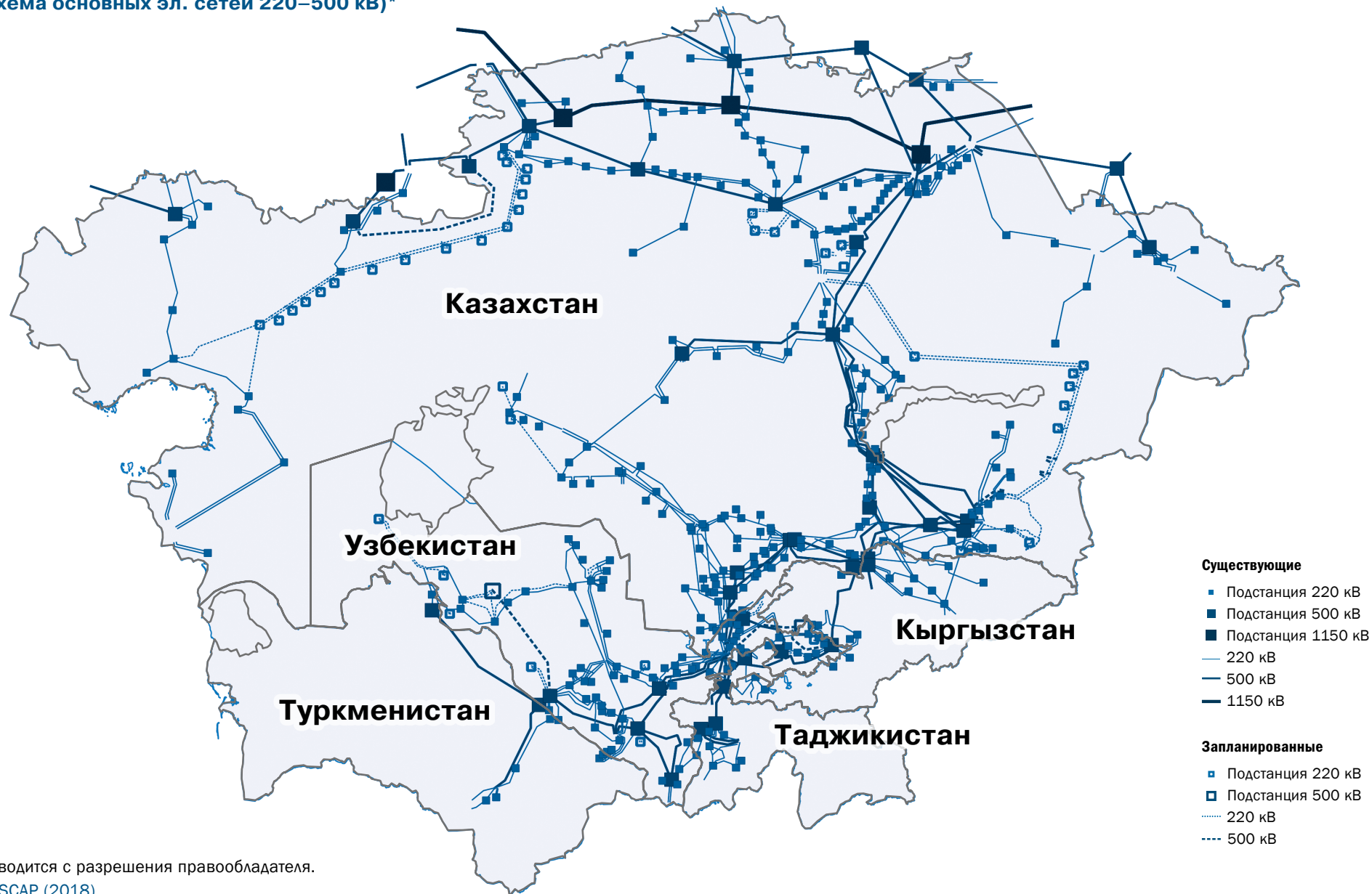
Рисунок 9. Центрально-азиатская энергетическая система (карта-схема основных эл. сетей 220–500 кВ)*
