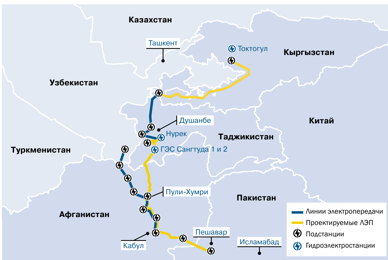
Рисунок 28. Схема передачи электроэнергии по проекту CASA-1000
