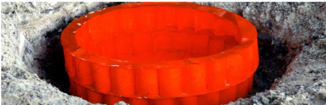
Полимерный резервуар с арочно-ярусной конструкцией стенки диаметром 36 метров и объемом 10 000 м 3 (экспериментальный образец)
