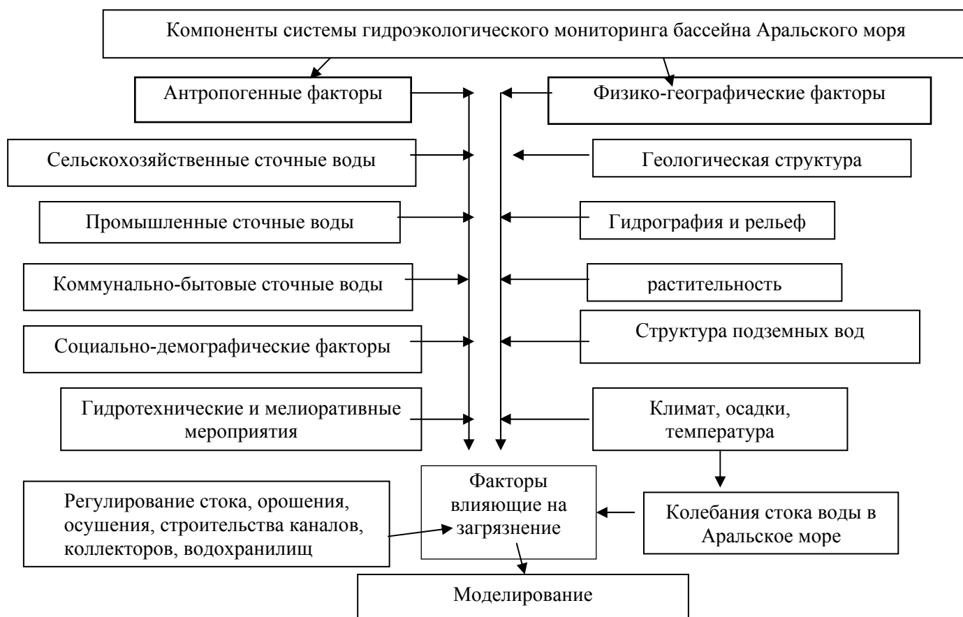
Рис. 1. Главные компоненты системы гидроэкологического мониторинга бассейна Аральского моря(ASBMS)
