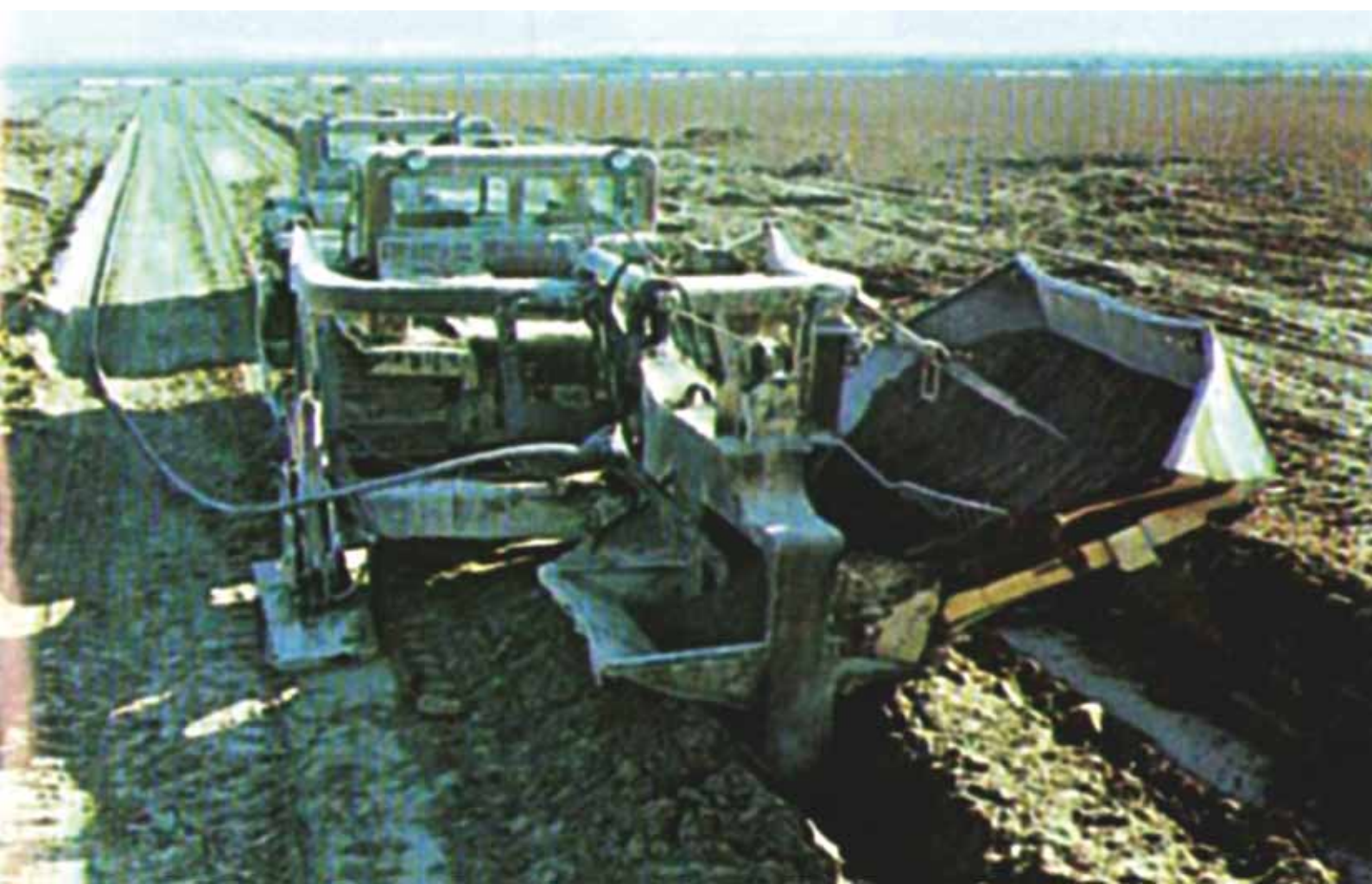
Бестраншейный дреноукладчик в Голодной степи (1970-75) The trenchless drainage machine in the Golodnaya Steppe (1970-75)
