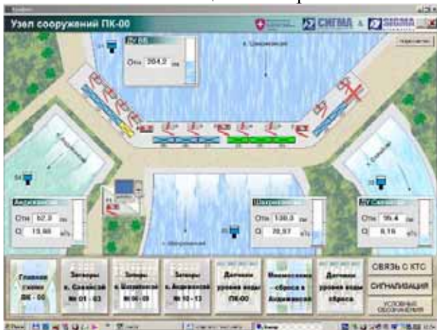
Рис. 7. Кампирраватский гидроузел главная мнемосхема системы SCADA
