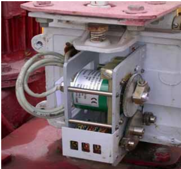
Рис. 5. Датчик положения затвора (ДПЗ)
