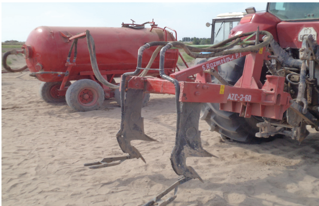
Рис 2. Комбинированное устройство (НАД-2-60М (АЗС-2-60К)) для глубокого рыхления грунта с одновременным внутривпочвенным внесением жидких органоминеральных удобрений
