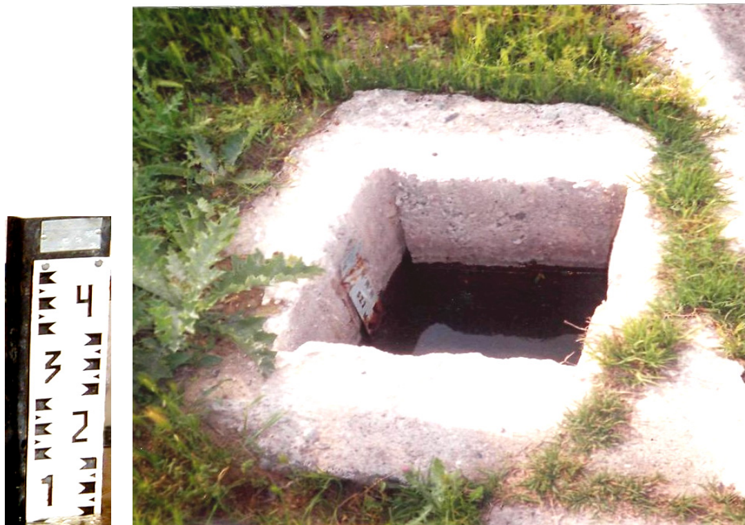
Успокоительный колодец с уровнемерной рейкой:
