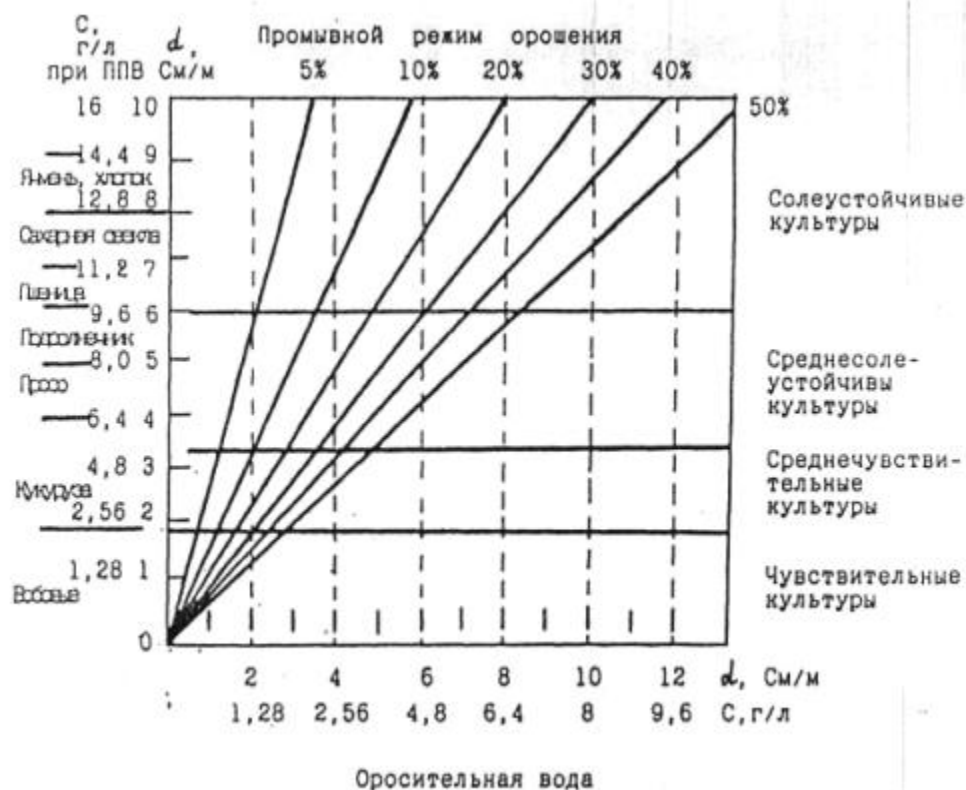
Рис.2.1. Зависимость между средней величиной засоления корнеобитаемого слоя (насыщенной пасты), минерализацией оросительной воды и интенсивностью промывного режима орошения:
