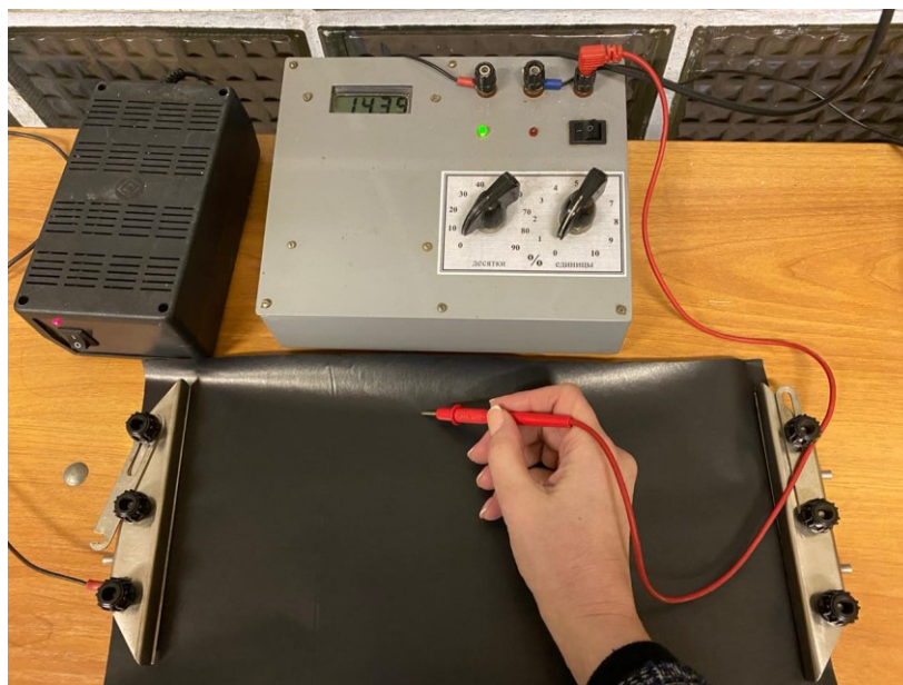
Рисунок 3 – Общий вид модели из электропроводной бумаги (автор фото Е. О. Скляренко)
