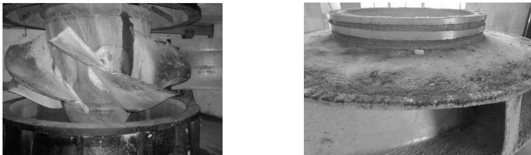
Рисунок 3 – Состояние рабочих колес осевых насосов Каршинского магистрального канала и центробежных Аму-Бухарского машинного канала из-за абразивного и кавитационного износа лопастей (автор фото НИИИВП)
