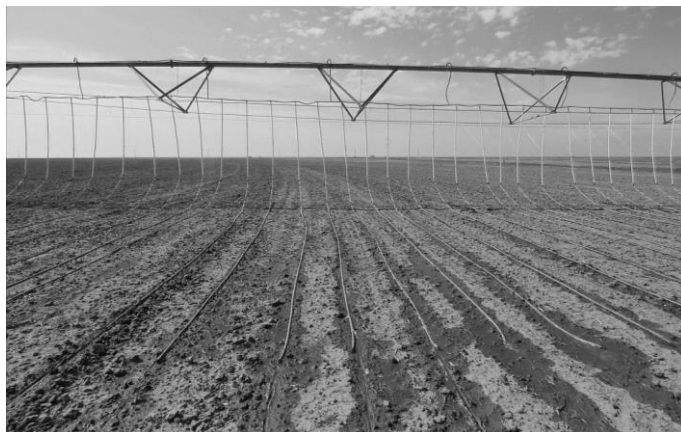
Рисунок 4 – Крыло дождевальной машины с системой PMDI с трубками точечного полива [11]
