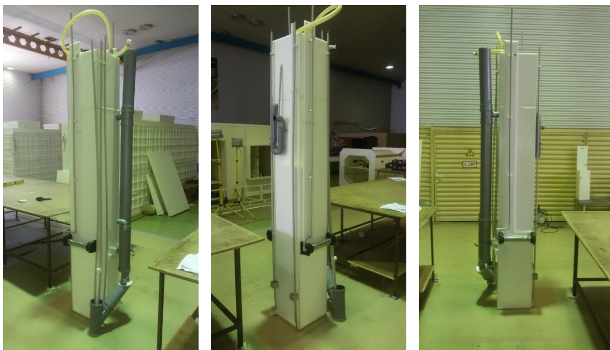
Рисунок 3 – Опытный образец КМО с суточной производительностью 1 м 3 (автор фото Е. А. Дугин)
